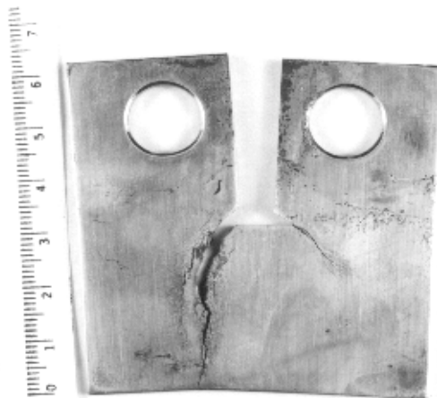
Figura 5 – CP trincado por CST através do ensaio de carga constante no eletrodo. Sistema: aço inoxidável austenítico (ABNT 304)/1M HCl ( \text{pH} \cong 0,00 ), K_I = 35 \text{ MPa}\sqrt{\text{m}}
