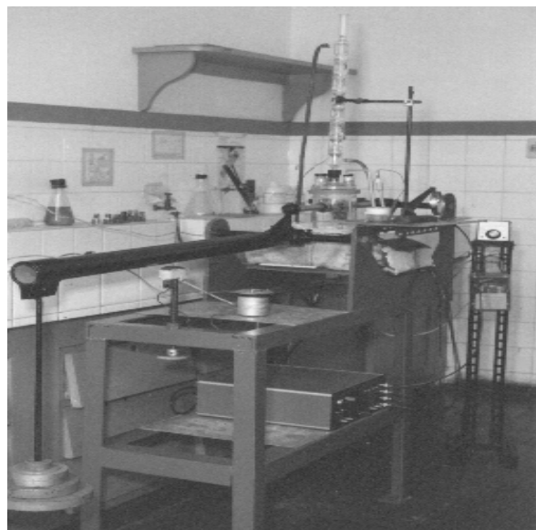
Figura 2 – Equipamento para aplicação de carga constante – sistema de peso morto
